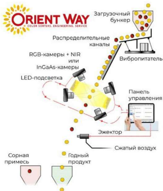
Рисунок 1.2 – Пример работы оптической сортировки
