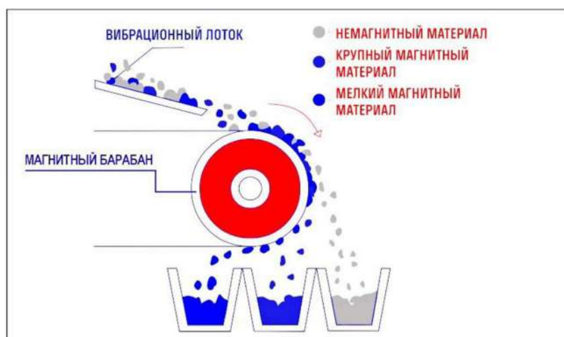
Рисунок 1.4 – Пример работы магнитного сепаратора
