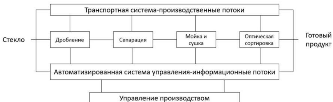
Рисунок 1.1 – Общая схема процессов переработки стекла
